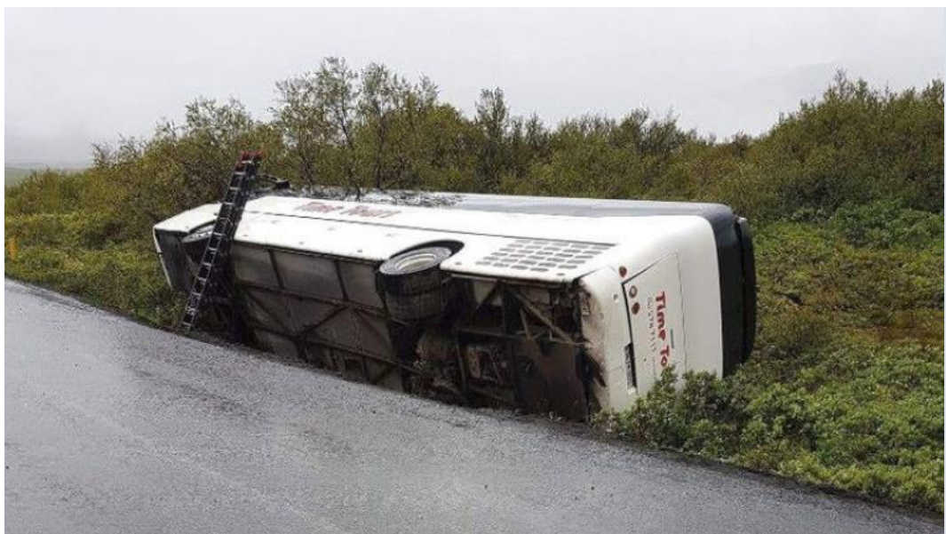
Mynd 2.3 Rúta sem valt á Pingvallavegi þegar vegkantur gaf sig í júlí 2017. Ljósmynd: Vegagerðin.
